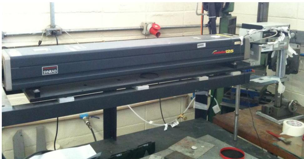
Figura 1. Laser de CO<sub>2</sub>
