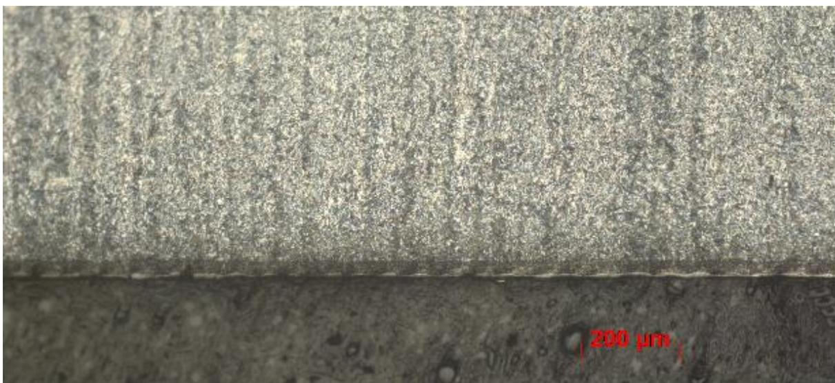
*Figura 14 Camada AISI 4340 com velocidade de 400 mm/s, 2 passes e resolução de 400 ppp*
