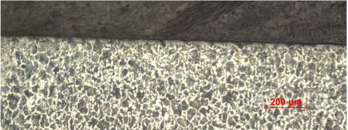
*Figura 20 Camada AISI 1020 com velocidade de 400 mm/s, 1 passes e resolução de 400 ppp*
