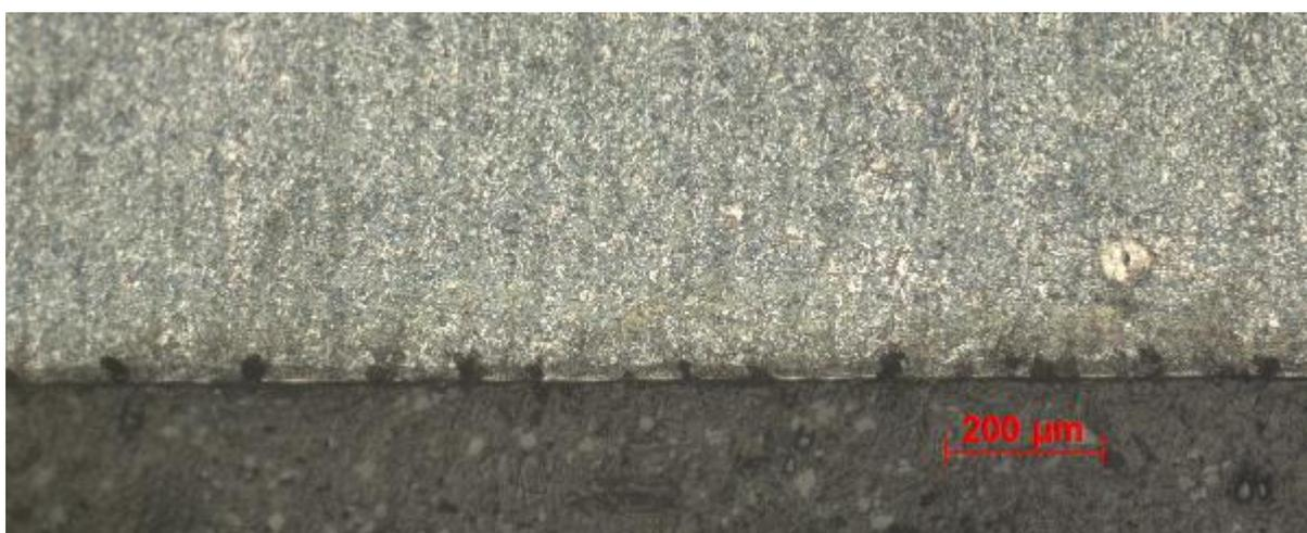
*Figura 15 Camada AISI 4340 com velocidade de 1000 mm/s, 2 passes e resolução de 400 ppp*
