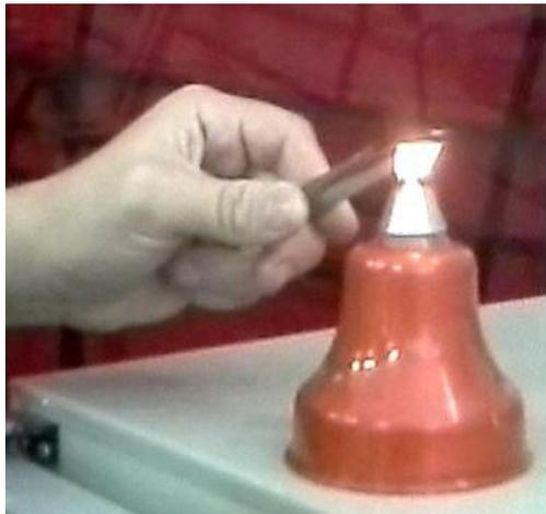
*Figura 3 Método de deposição de Negro de fumo*
