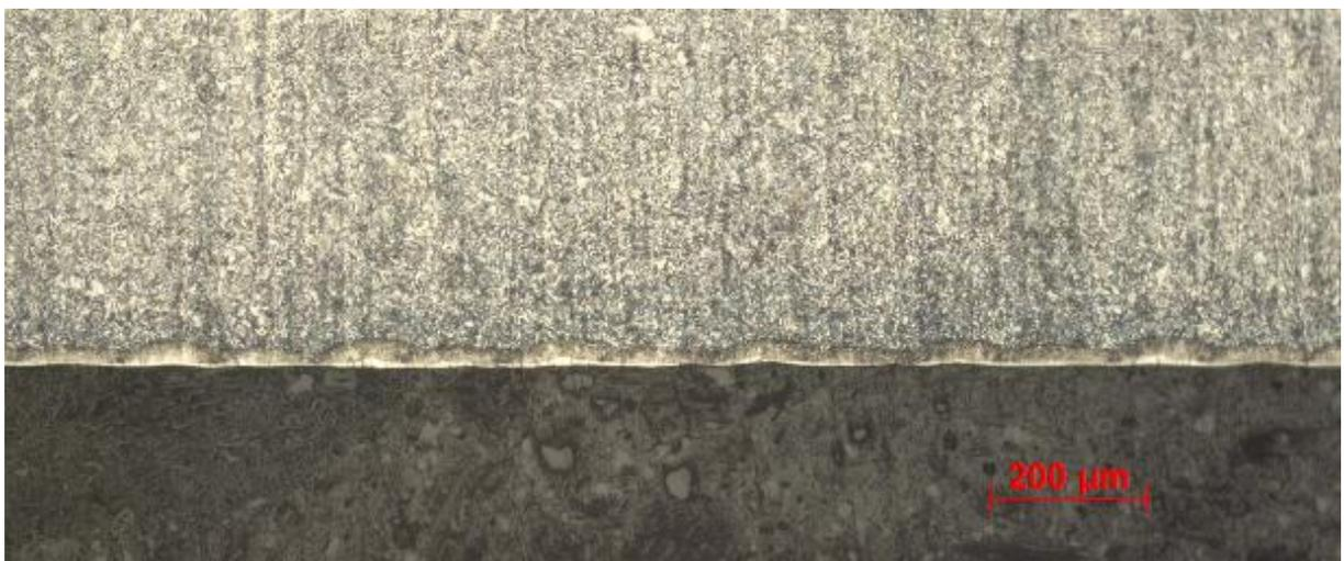
*Figura 11 Camada AISI 4340 com velocidade de 1000 mm/s, 2 passes e resolução de 200 ppp*
