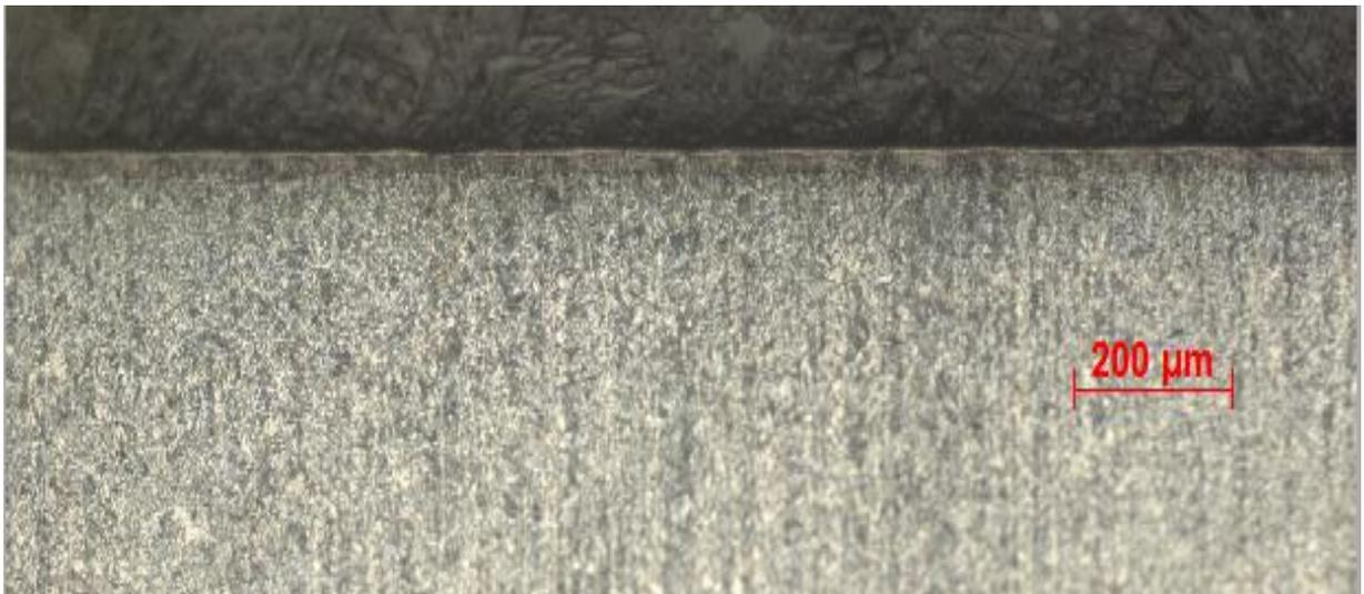
*Figura 13 Camada AISI 4340 com velocidade de 1000 mm/s, 1 passe e resolução de 400 ppp*
