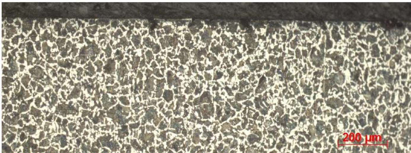
*Figura 16 Camada AISI 1020 com velocidade de 400 mm/s, 1 passe e resolução de 200 ppp*
