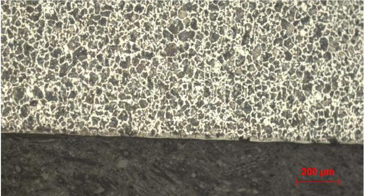
*Figura 18 Camada AISI 1020 com velocidade de 400 mm/s, 2 passes e resolução de 200 ppp*
