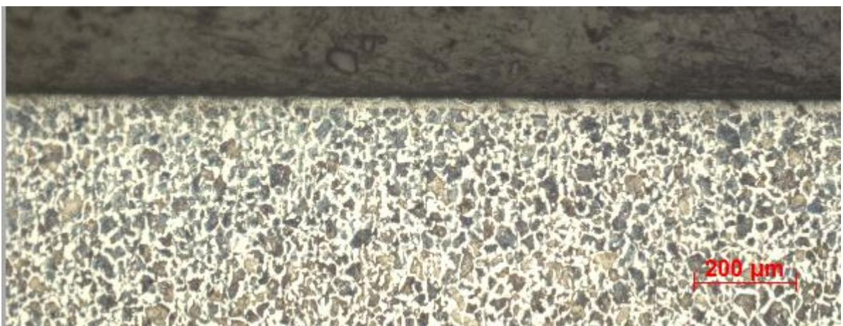
*Figura 21 Camada AISI 1020 com velocidade de 1000 mm/s, 1 passes e resolução de 400 ppp*
