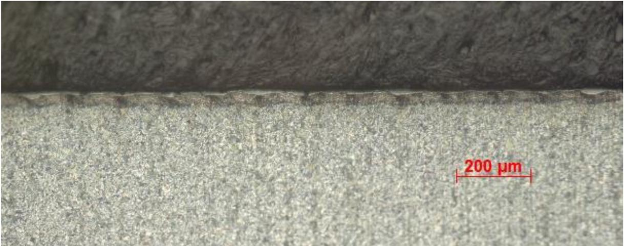
*Figura 12 Camada AISI 4340 com velocidade de 400 mm/s, 1 passe e resolução de 400 ppp*
