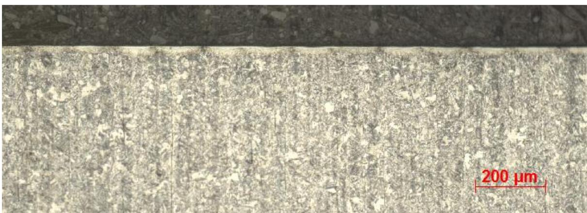
*Figura 9 Camada AISI 4340 com velocidade de 1000 mm/s, 1 passe e resolução de 200 ppp*
