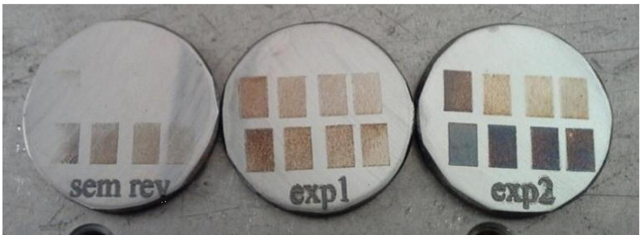
*Figura 6 Amostras após serem Irradiadas. Da esquerda para direita: 1) sem revestimento, 2) Exp 1 com revestimento e resolução de 200 ppp, e 3) Exp 2 com revestimento e resolução de 400 ppp.*
