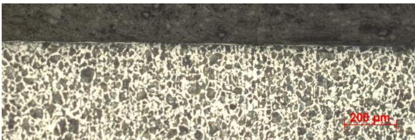
*Figura 17 Camada AISI 1020 com velocidade de 1000 mm/s, 1 passe e resolução de 200 ppp*
