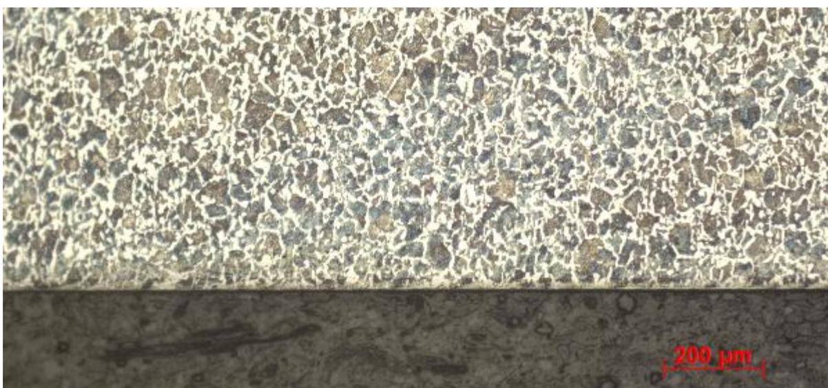
*Figura 23 Camada AISI1020 com velocidade de 1000 mm/s, 2 passes e resolução de 400 ppp*
