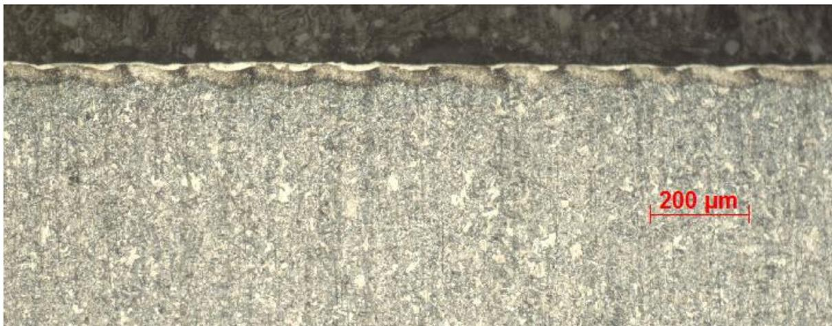
*Figura 8 Camada AISI 4340 com velocidade de 400 mm/s, 1 passe e resolução de 200 ppp*
