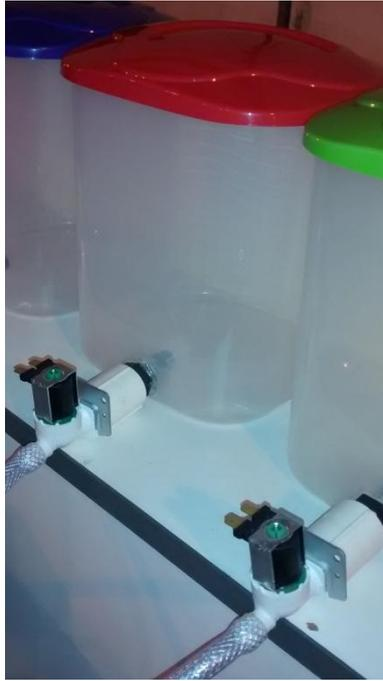
Figura 14. Implantação da válvula
