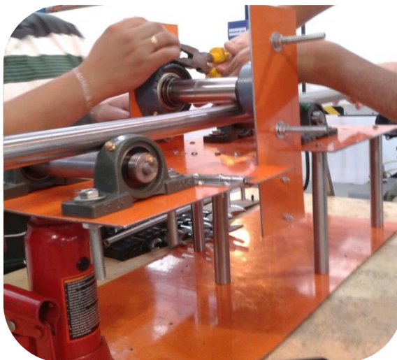
Figura 26: Fixação dos mancais de parede.
