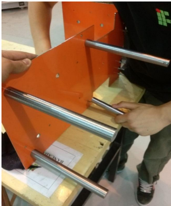
Figura 24: Fixação dos tirantes.
