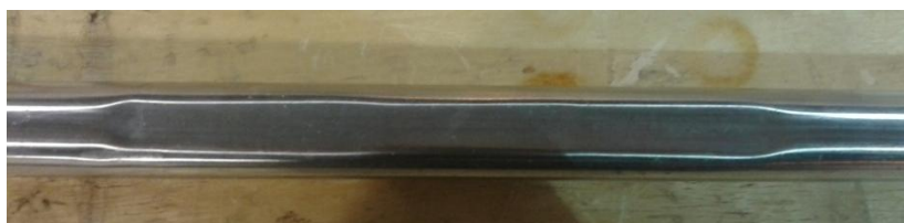
Figura 28: Achatamento do tubo.
