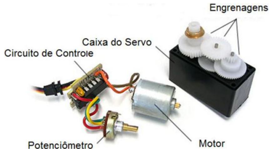
Figura 9 – Componentes internos do servo motor
