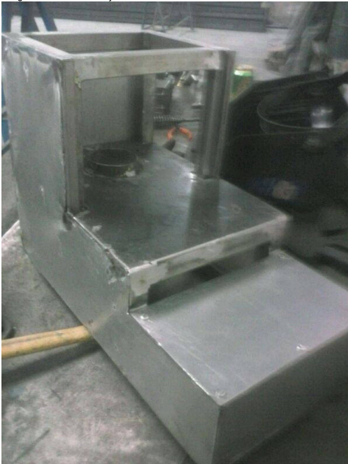
Figura 6. Montagem da Carcaça
