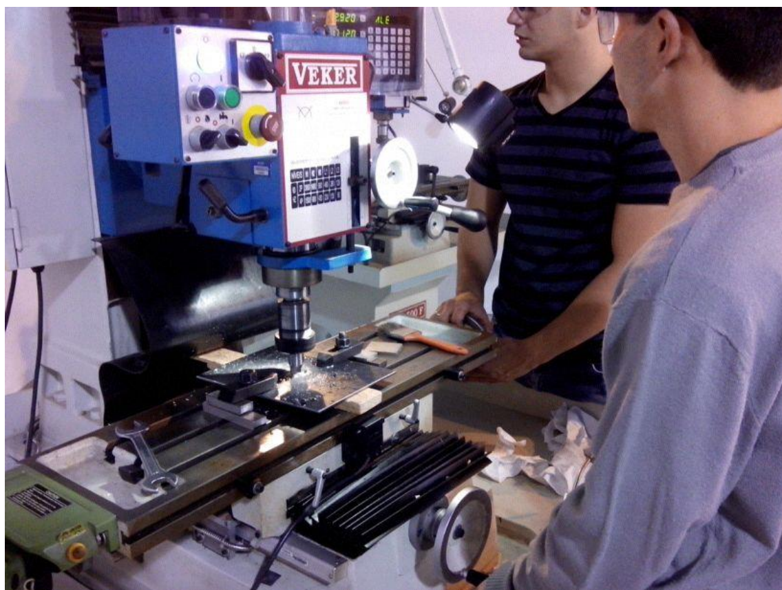
Figura 10. Fabricação de peça para base do cilindro.
