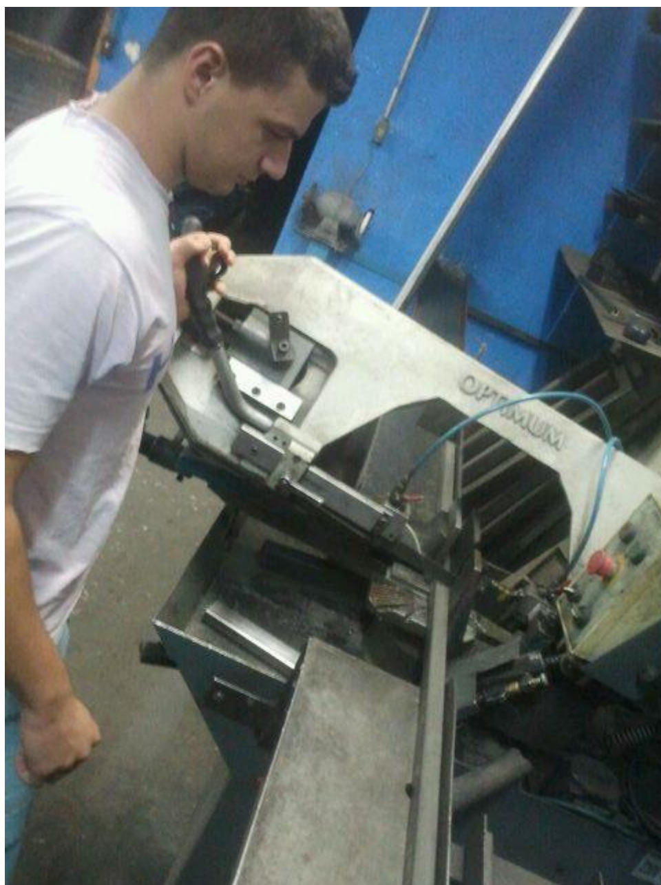
Figura 4. Corte de perfil para montagem de estrutura.
