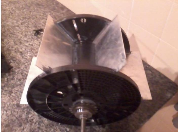
Figura 3: Colagem das chapas de alumínio no carretel de PVC com a cola *Loctite EA 9460* epóxi.
