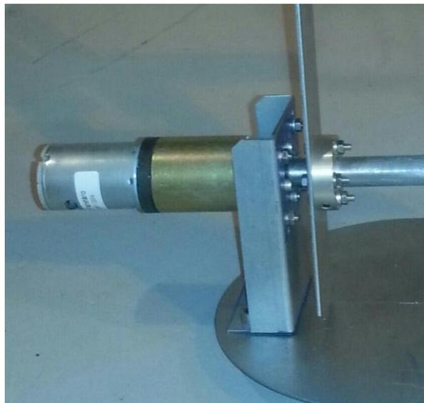
Figura 2: Motor de 12 Volts com redutor de velocidade.
