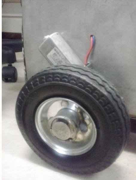
Figura 1. Acoplamento do motor na roda
