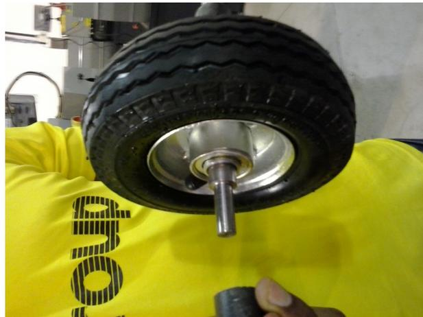
Figura2. Eixo acolplado na roda.
