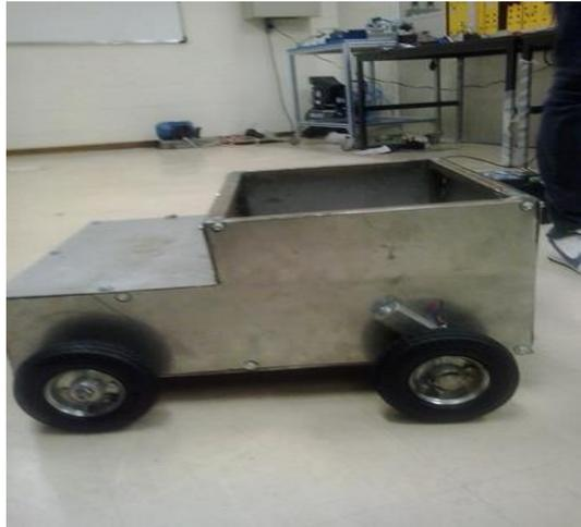
Figura5. Chapa galvanizada nas laterais.
