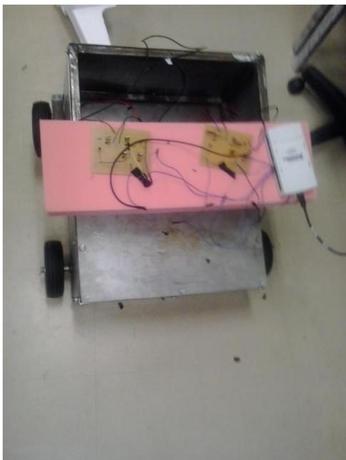
Figura 7. Placas e fios para alimentação do robô.
