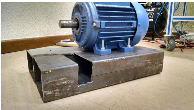
Figura 6 . Base metálica utilizada para fixação do motor e ensaios com o rotor bloqueado
