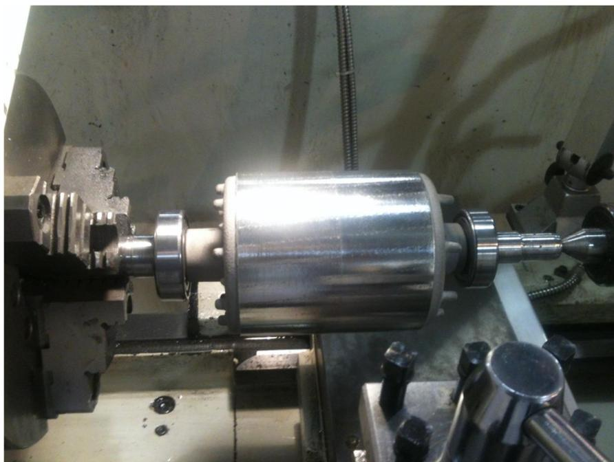
Figura 12 . Rotor após usinagem.
