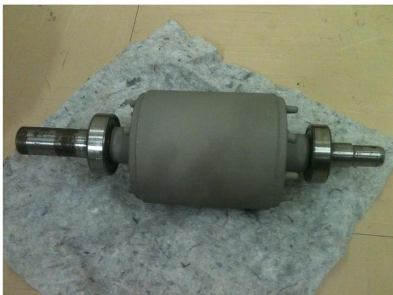
Figura 11 . Rotor do tipo gaiola de esquilo após receber tratamento HVOF.
