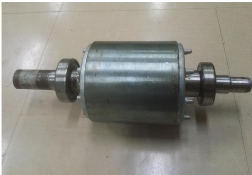
Figura 10 . Rotor do tipo gaiola de esquilo em que foi feito o estudo, antes do tratamento térmico.
