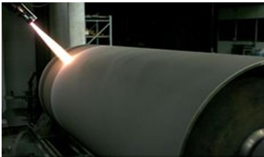
Figura 4 - Peça em processo de aspersão térmica HVOF
